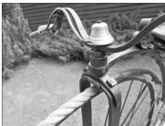
Izdomas bagāti risinājumi. Vēl viens no atjautīgiem velosipēda konstrukcijas un kalēja risinājumiem bija oriģināla signālierīce – liets bronzas zvans, kuru skandināja ar speciāla mehānisma palīdzību.
