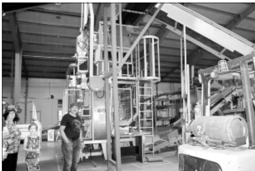
Pēc receptēm. Substrātus gatavo pēc receptēm. Tehnoloģiskās iekārtas apkalpo mišmeistars , kā viņu dēvē rūpnīcas žargonā, kurš ar datora atbilstošas programmas palīdzību dozē vajadzīgās frakcijas kūdras, pievienojot tai konkrētus citu vielu daudzumus pēc noteiktās receptes. Piedevās liek, piemēram, minerālmēslus, mālu, kaļķi, vēl citas vielas. To visu samaisa kopā vajadzīgajā substrātā, kas tālāk jau gatava produkta veidā nonāk attiecīgā fasējuma maisā. Pasūtīt sev vēlamo substrātu pēc savas receptes, kā stāstīja Jānis Dimants, var jebkurš, galvenais, lai ir vēlme un nauda. Mazākais apjoms, ko te var iegādāties uz vietas, ir desmit kubikmetri.
